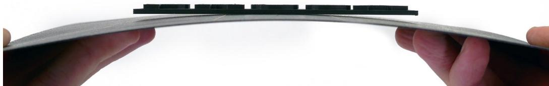
Image 13 - Retrait du modèle de la surface d'impression en PEI en courbant la feuille en acier
