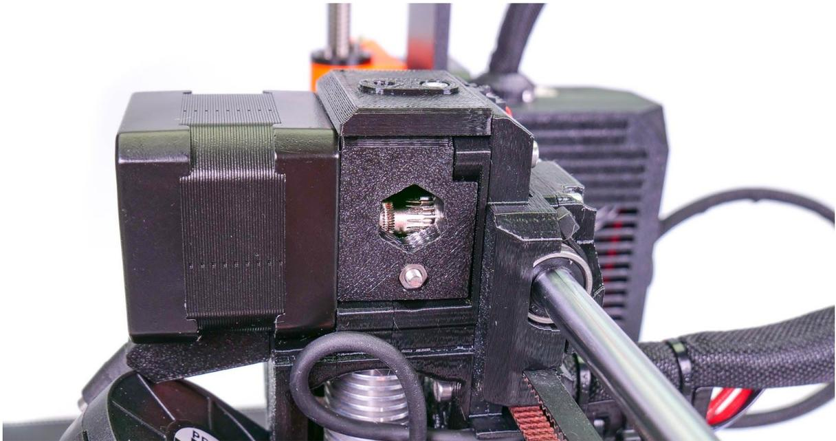
Image 41 - Nettoyage de l'extrudeur - vous pouvez voir la poulie dentée à travers le trou de service
