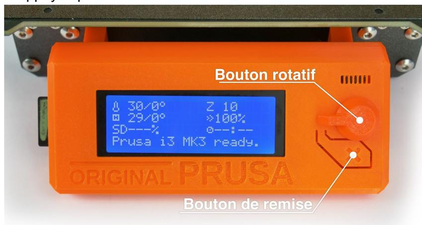
Image 15 - L'écran LCD et les boutons de contrôle
