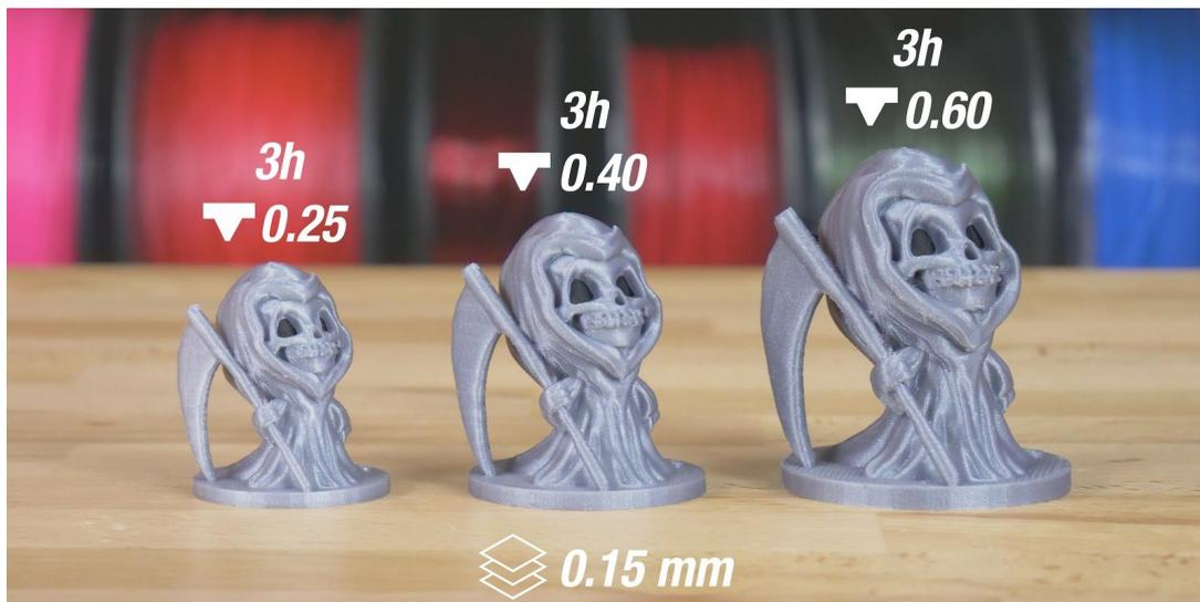
Image 22 - Les différentes tailles de buses ont un impact important sur la vitesse d'impression
