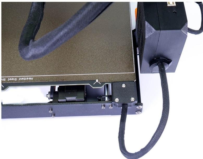
*Image 50 - Les câbles doivent être enveloppés dans une gaine textile*
