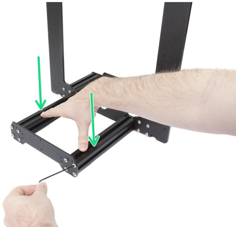
*Image 46 - Comment serrer correctement ensemble le cadre, les platines et les extrusions.*
